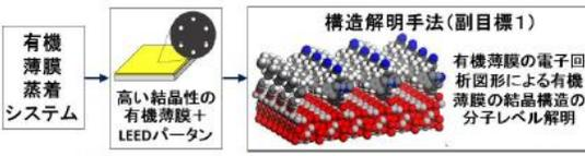
有機薄膜蒸着システム → 高い結晶性の有機薄膜 + LEEDパターン → 構造説明手法(副目標1) → 有機薄膜の電子回析図形による有機薄膜の結晶構造の分子レベル説明
